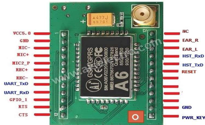
Figure3.3: GSM A6 Module (Audrey selian, 2005).
